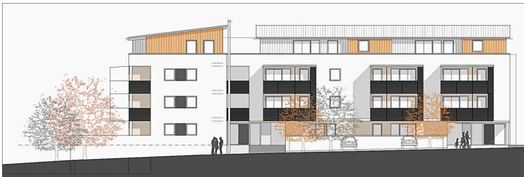
33 Wohnungen werden an der Karlsbader Straße neu gebaut: 15 Zweizimmerwohnungen, drei 2,5-Zimmer-Wohnungen, zwölf Dreizimmer-Wohnungen und drei Vier-Zimmer-Wohnungen. Eine Besonderheit sind die Laubgänge zu den Wohnungen. Das oberste Geschoss ist zurückgenommen, damit dort Dachterrassen entstehen können. (Zeichnung: Büro Kirchmair+Meierhofer)
